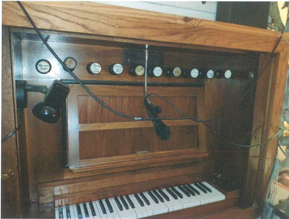
Stół gry – wyciągi rejestrowe, pulpit nutowy i klawiatura manualu.
